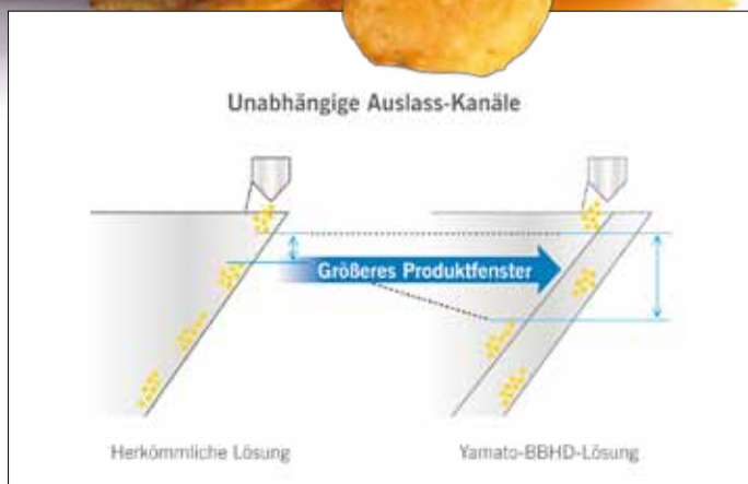
Bottom-Based-Handling-Device für eine kontrollierte Produktübergabe. Vergrößert die Abstände zwischen den Produktabwürfen und sorgt für saubere Siegelnähte.
